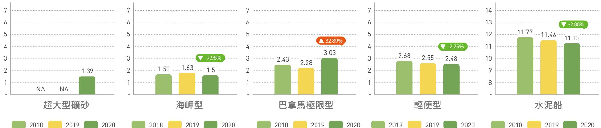
註：燃油消耗指數(FCI)= 燃油消耗 \* $10^6$  /載重噸 \* 距離(g / t-nm)(船舶每載 1 噸貨物，航行 1 海浬，所耗油量); 值愈小，代表愈省油
